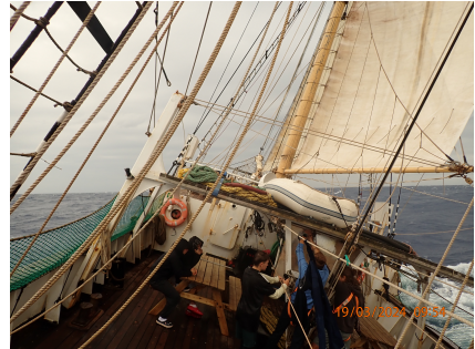
Abbildung 10.2: Das frontale Auf und Ab durch Wellentäler und -berge heisst Stampfen.
