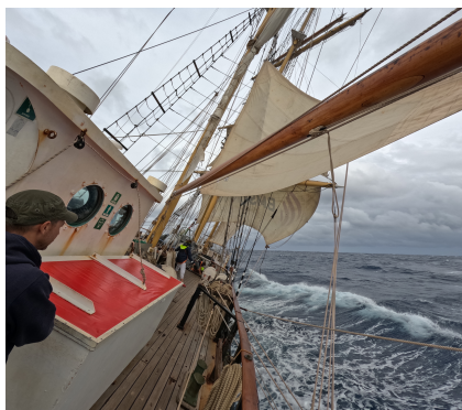
Abbildung 10.4: Krängung (engl. heel ), Seegang und das Rollen entstehen durch Wind.
